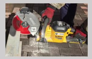
Il Disco diamantato Special Rescue di nuova concezione appositamente studiato per le molteplici tipologie di interventi su materiali diversi, utilizzabile sia a secco che a umido. Il principale vantaggio di questo nuovo disco è di essere privo di scadenza e garantire, fino al suo totale esaurimento, sempre la stessa profondità di taglio.
